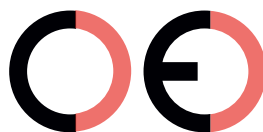
Faux marquage CE (trop éloigné)
